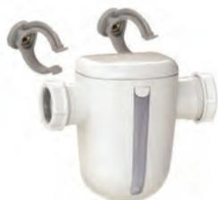
Neutralizzatore di condensa per caldaie murali fino a 25kw., ingombro ridotto. Possibile collegamento superiore o laterale. Diametro 32 mm. A corredo: supporti di fissaggio, una confezione di granuli Sanisal (3350610).
