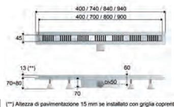
(\*\*) Altezza di pavimentazione 15 mm se installato con griglia coprente
